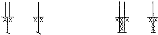
Boret i antatt fjell. (Hvis overgangen er ukjent, settes spørsmåltegn.) Boret i fjell og kjerne opptatt.
