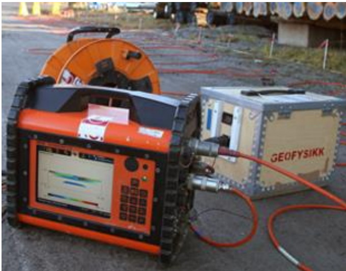
Figur 3. ABEM Terrameter LS2 benyttet til ERT-målingene
