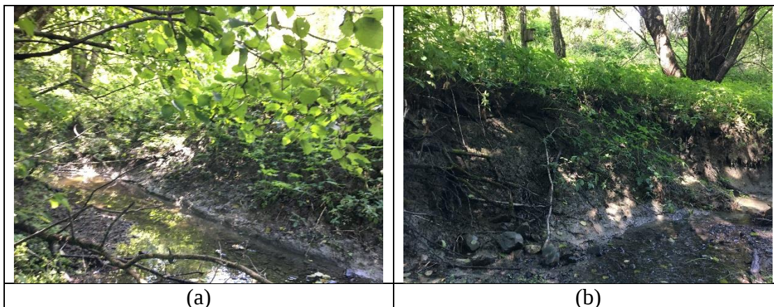
Figur 13 Fotografier fra befaring, Sted 13: (a) og (b) erosjon og utglidninger i leire, nedenfor borpunkt 2013.
