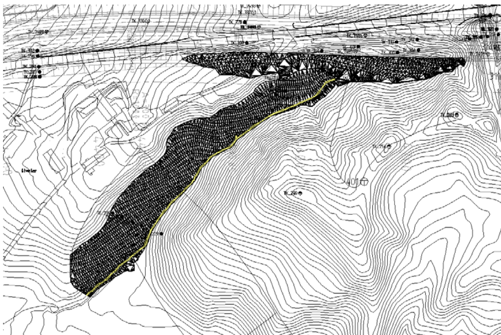
Figur 5: Plassering av motfylling
