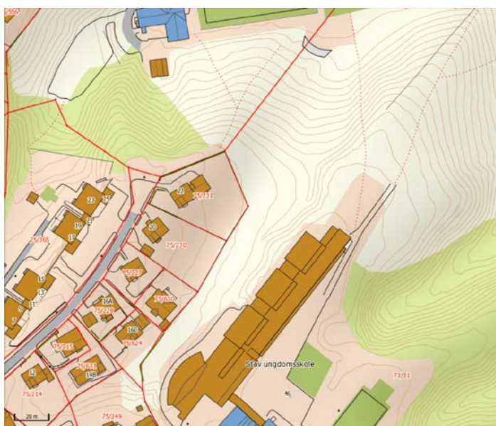
Figur 8 Terreng (1 m koter) etter oppfylling av ravine vest for Stav ungdomsskole. Ravinen er så godt som fullstendig gjenfylt.
