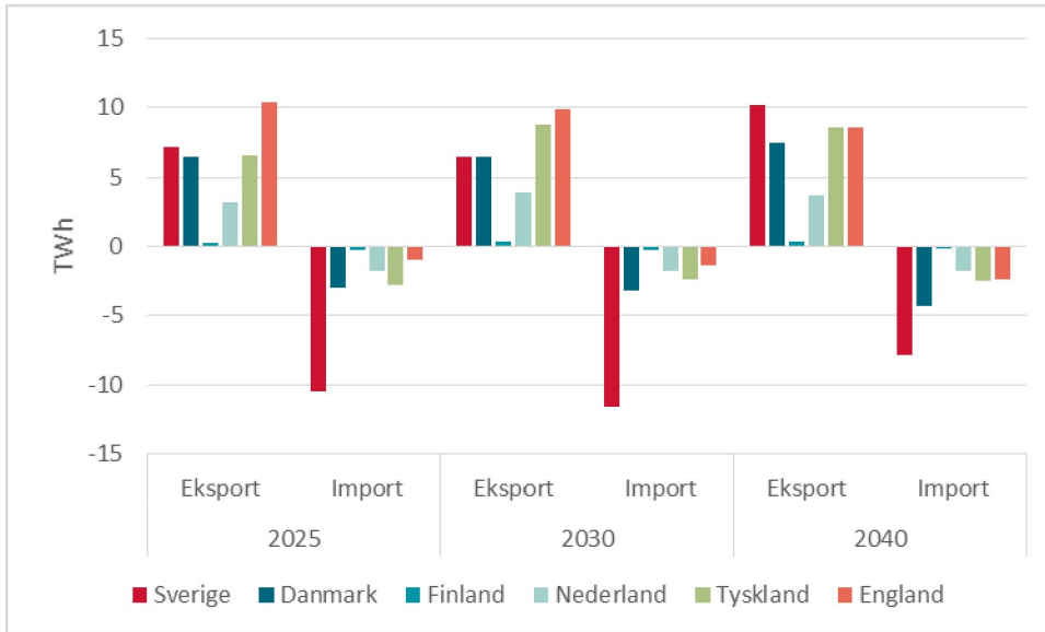
Figur 18 Flytmønster på mellomlandsforbindelser til og fra Norge uten NorthConnect i ulike modellår; TWh
