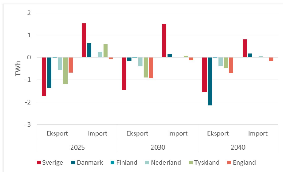
Figur 21 Endring i kraftutveksling på øvrige forbindelser av NorthConnect per modellår, TWh/år
