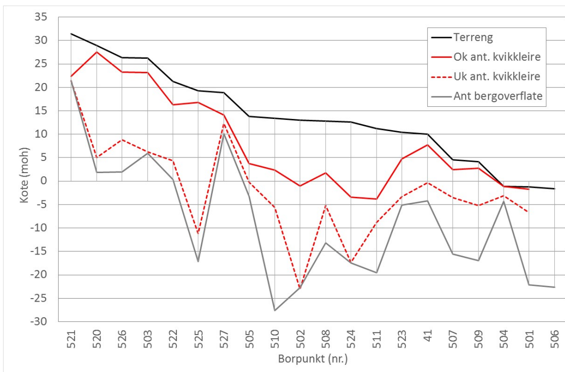
Figur 2 Tolket lagdeling (kvikkleire) i borerer innenfor Gjelstad kvikkleiresone. Boringene er sortert etter kotehøyde for terreng ved borpunktet (men fremstiller ikke et sammenhengende terrengprofil).
