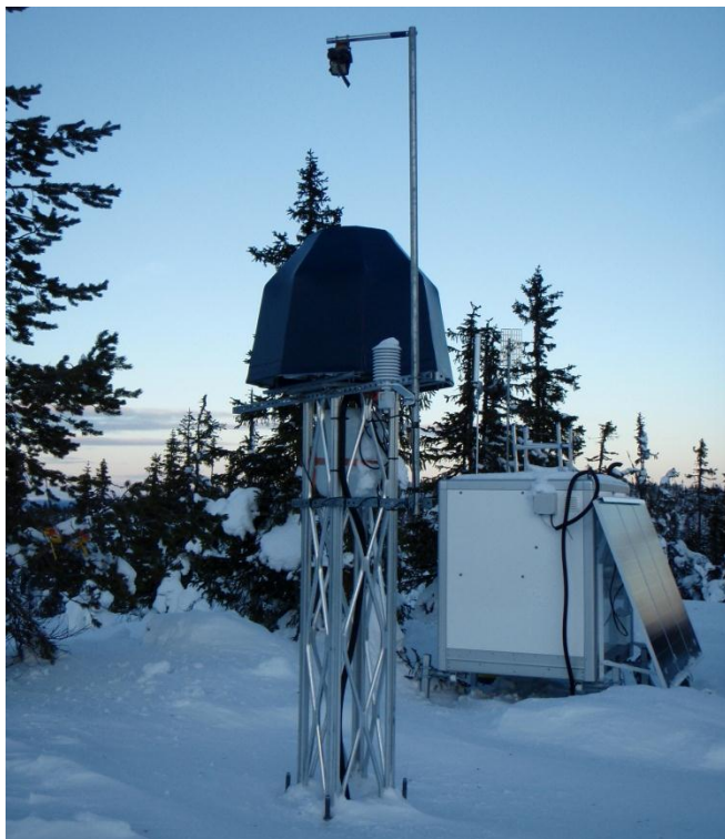
Figur 6-2: Lasermåleinstrumentet (lidar) utplassert ved et av tre lidarmålepunkter innenfor planområdet. Kjeller Vindteknikk AS
