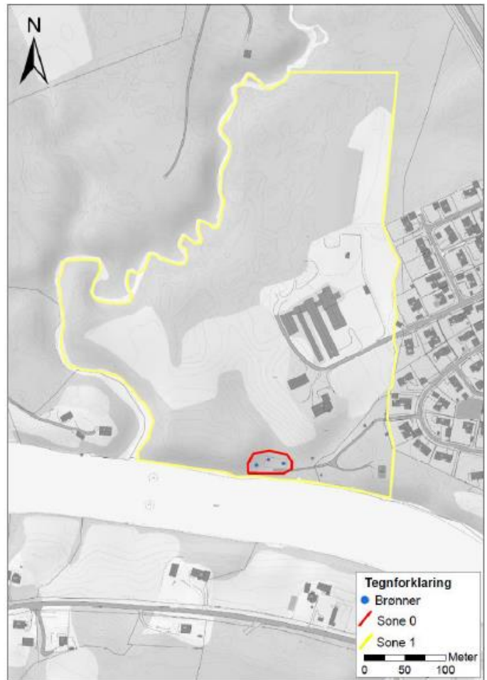
Figur 5 klausuleringszone ved Hvittingfoss vannverk
