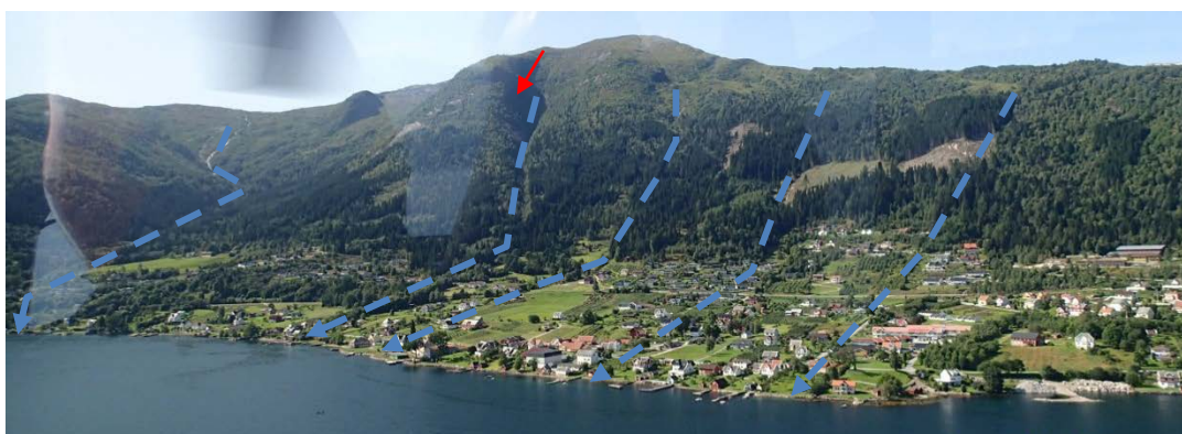
Figur 12. Balestrand sentrum og fjellsida bak. Blåhella (sva hvor det løsner snøskred) er markert med rød pil. Skredbaner for snø- og sørpeskred er vist med blå piler.
