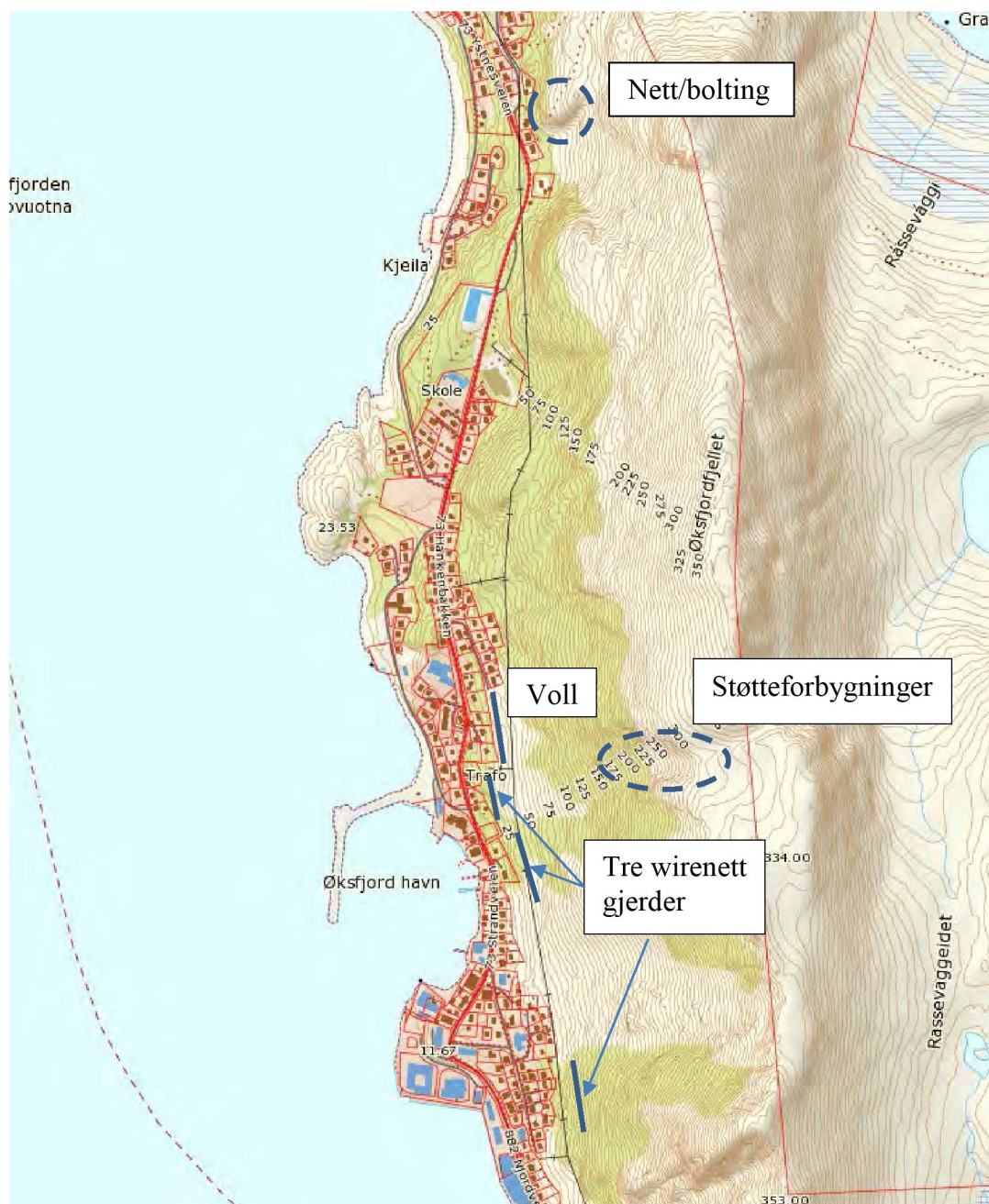
Figur 31 Sikringstiltak i Øksfjord
