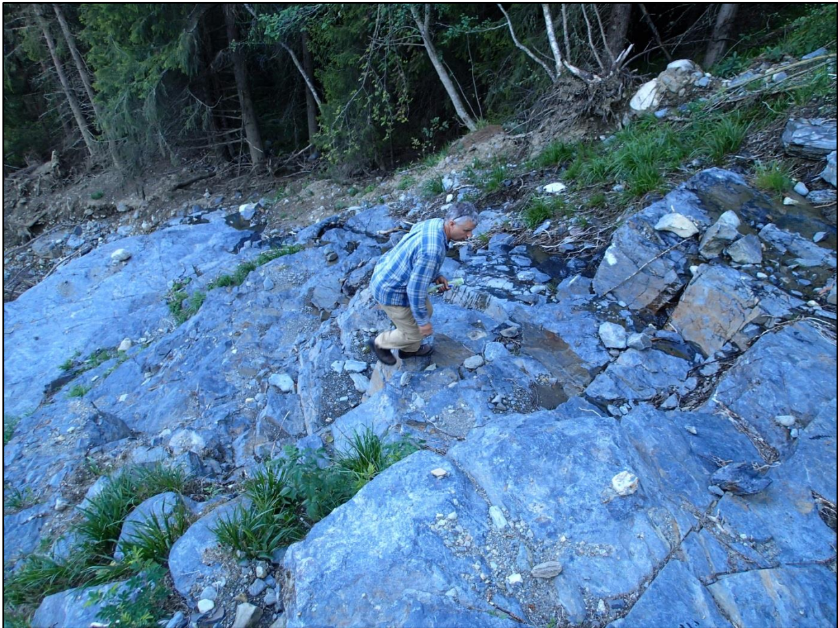
Figur 12 I skredbanen til det største skredet 22. mai 2013 er det renvasket fjell med helning på rundt 35° og relativ liten ruhet. Dette er et potensielt utløsningsområde for snøskred.
