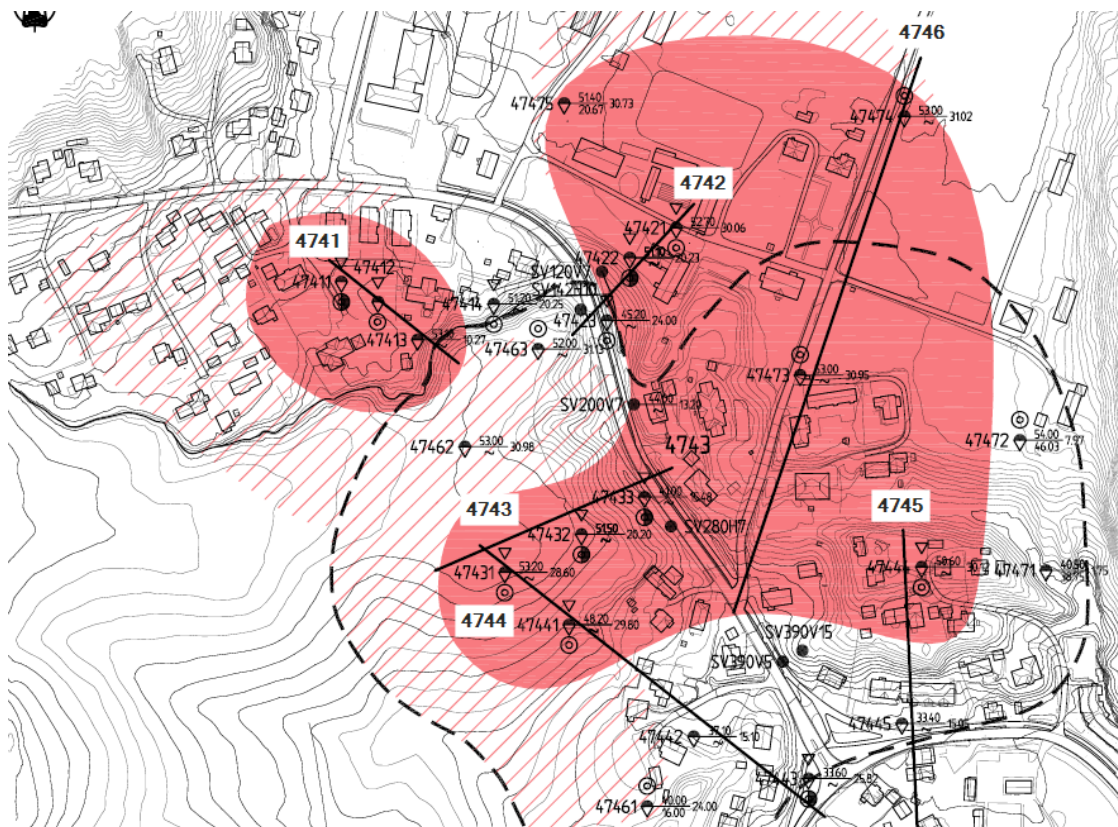
Figur 11: Representative (kritiske) snitt/profiler innenfor kvikkleiresonen «474 Sanssouci».
