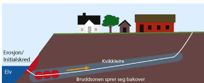
Figur 10: Illustrasjon bakoverrettet flakskred iht. NVE veileder 7/2014.
