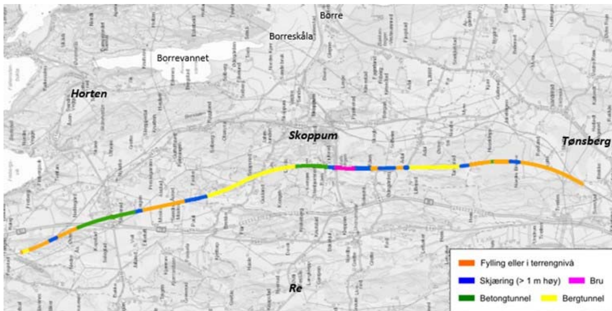
Figur 4-1: Valgt strekning Nykirke – Barkåker, "Skoppum Vest". Det indikeres om det planlegges bru (rosa), bergtunnel (gul), betongtunnel (grønn) eller om sporet vil bygges i terrengnivå med fylling (oransje) eller med skjæring (blå).
