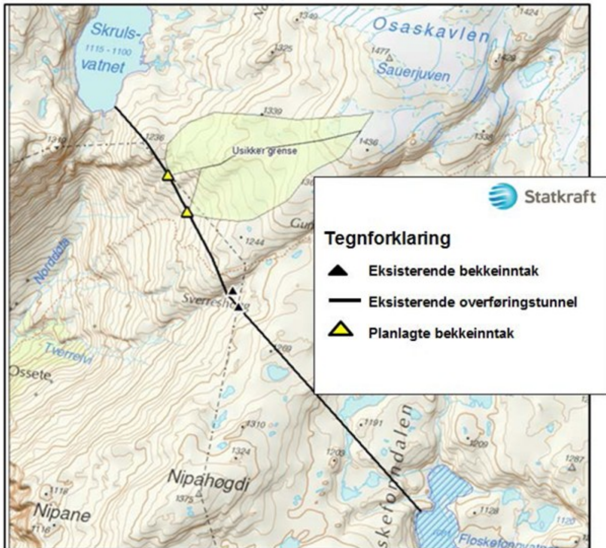
Figur 3.1 Utbyggingskart for overføring av bekkene på Osafjellet
