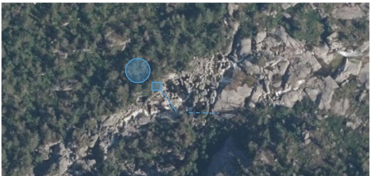
Figur 2 Streken viser plassering av sperredam og ringen viser mulig plassering riggområde. Firkanten viser lukehuset. Den stiplede linja viser en terskel for å lede vann mot inntaket.
