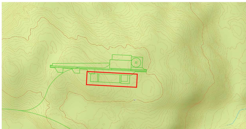
FIGUR 3: EKSEMPELTEGNING PÅ KRANOPPSTILLINGSPASS
