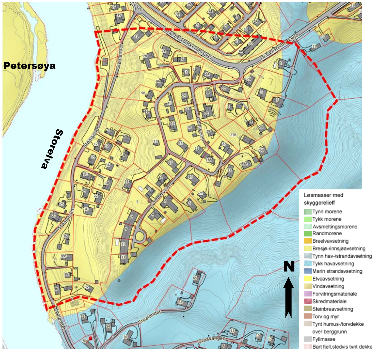
Fig. 2: Oversikt topografi, løsmasser, avgrensning kvikkleiresone før utredning (kilder: geo.ngu.no, atlas.nve.no)
