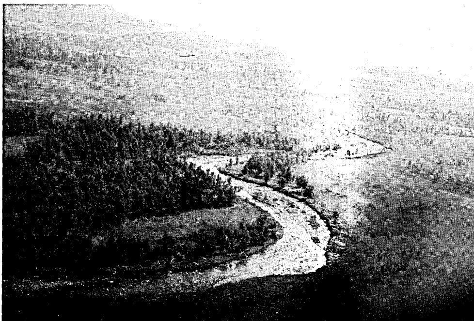
Fig. 14. Storåa er mellom kote 700 og 600 en typisk "bunntransportelvy" med flat bunn og grovt rundet materiale. Det materialet som tilføres fra områdene ovenfor, kan her i sin helhet transporteres videre.
