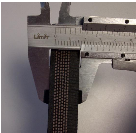
Figur 7-1. Bilde som viser tverrsnitt av gummibelg til en 4 meter høy Obermeyerluke 3
