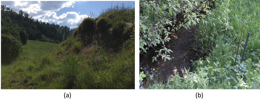
Figur 33. Fotografier fra befaring i området ved Sunde: (a) Mindre overflateglidning. (b) Lite erosjon, klart vann, liten vannføring
