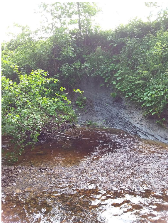
B 14 Aktiv erosjon. Leirskifer-struktur, antakelig meget fast, overkonsolidert leire.
