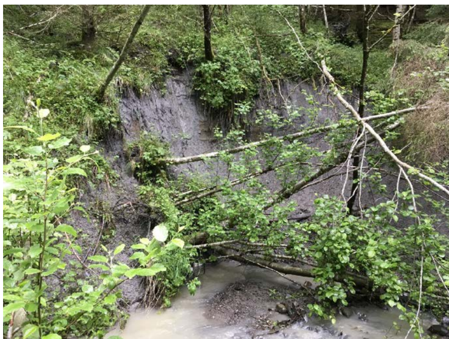
Bilde 4 Erosjon og utglidning på østsiden av bekken (utenfor sonen). Bruddkant ca 3 - 4 m. Leire, silt, sand og grus i erosjonssår. Bilde mot øst.
