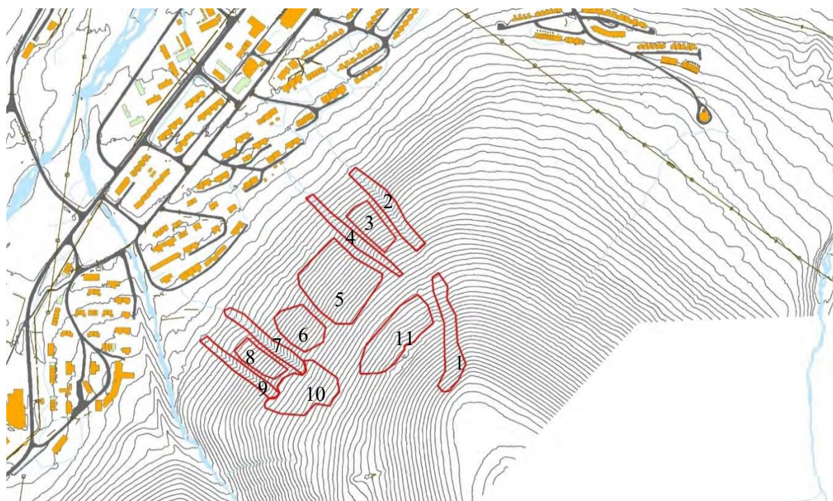
Figur 15: Skredbaner som er lagt til grunn for modellering av skred med årlig sannsynlighet 1/1000. Skredbane 1 løser først, for så å løse ut skredbane 2 og 3. Skred bane 11 løser ut skredbane 5 og 6. Skredbane 10 løser ut først, for så å løse ut skredbane 7, 8 og 9.
