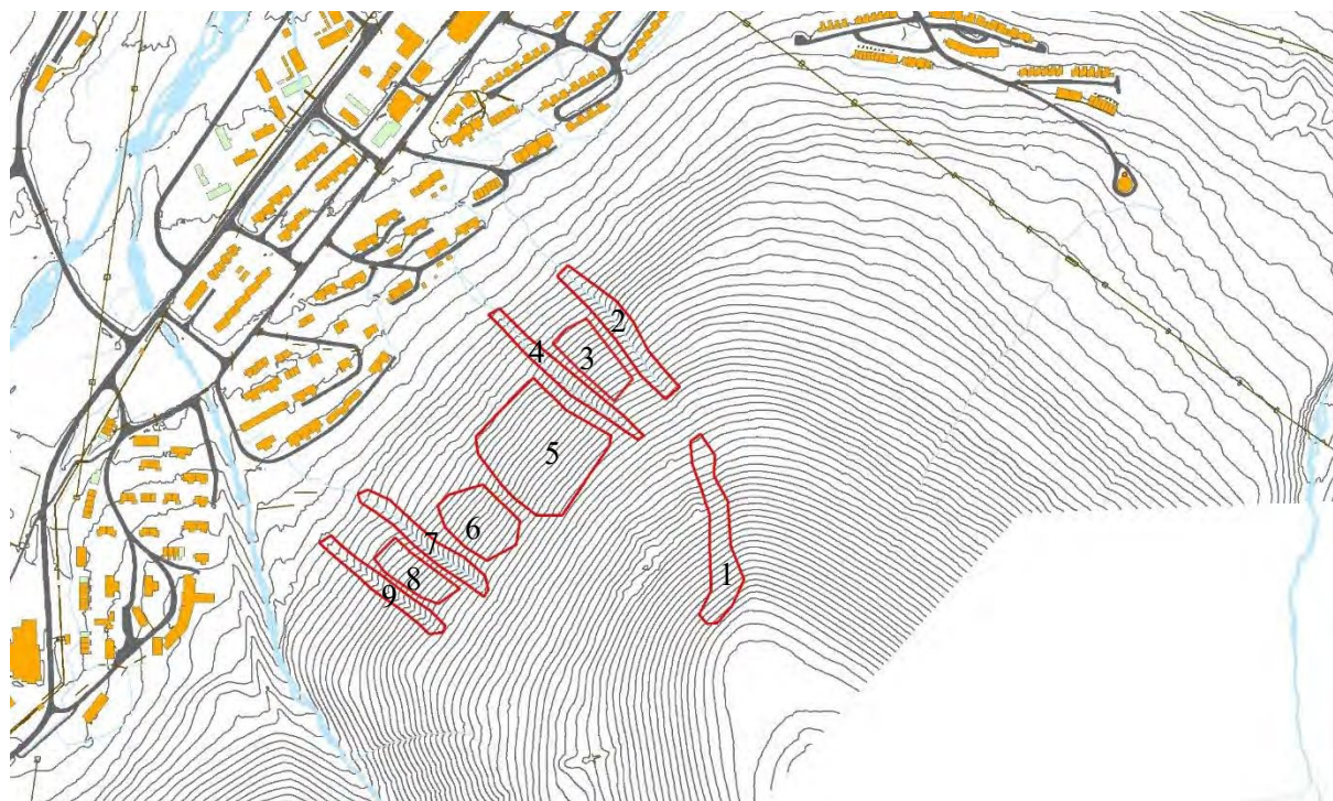
Figur 14: Løsneområder som er lagt til grunn for modellering for et scenario med årlig sannsynlighet 1/100. Skred nummer 1 løsner først og løser ut skred nummer 2. Snøskred nummer 3 – 9 løser ut hver for seg.
