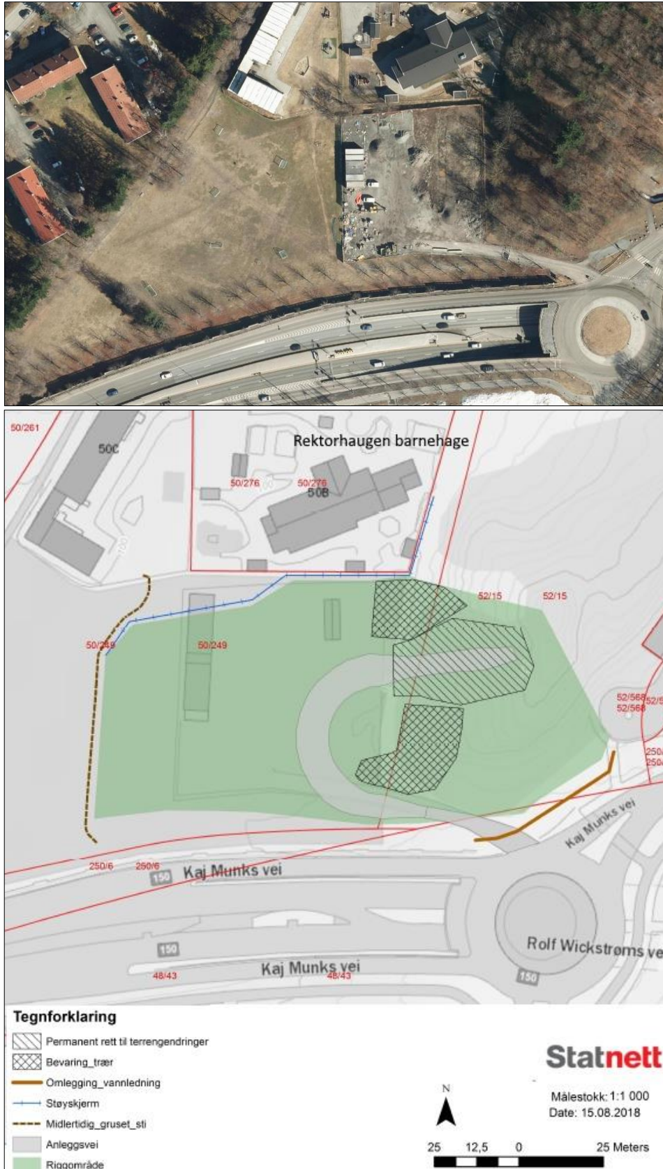
Figur 12: Planlagt arealbruk for rigg på Ullevåsletta. Tidligere riggområde til Vegvesenet vist i bilde over for sammenlikning. Kilde: Statnetts tilleggsopplysninger NVE 201800810-92 og flyfoto fra Finn.no.
