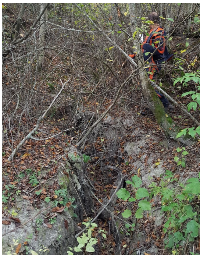
Figur H28 Sone 734 Nordli vest: Erosjonsrenne i sideravine mot vest fra bekken mellom sone 723 Nordli og 734 Nordli vest. Erosjon i siltig tørrskorpeleire, men også eksponert bløtere leire inne i ravinen. Foto: J. Wasrud, NVE
