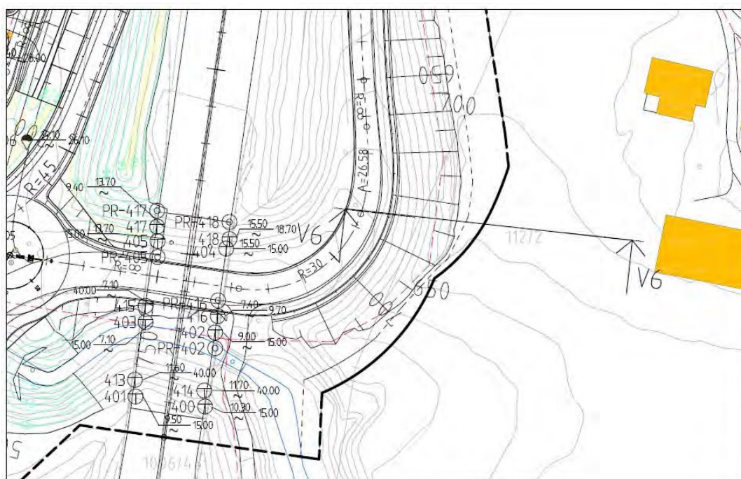
Figur 5-5-9 Plantegning med sonderinger og profil V6. Sonderinger er hentet fra SVV rapport Ud800A-17 ref. [11].
