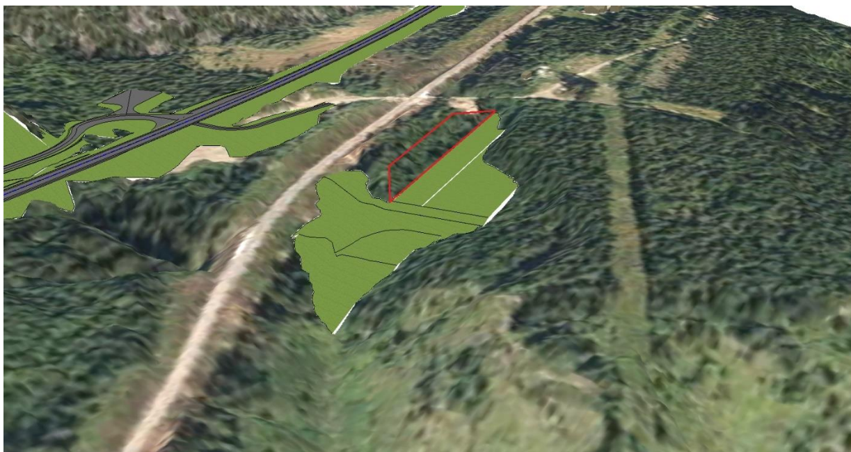
Figur: Utsnitt fra modellen med design av motfylling. Skråning markert med rødt skal i tillegg plastres med min. 0,5 meter stein opp til kote +103,5.
