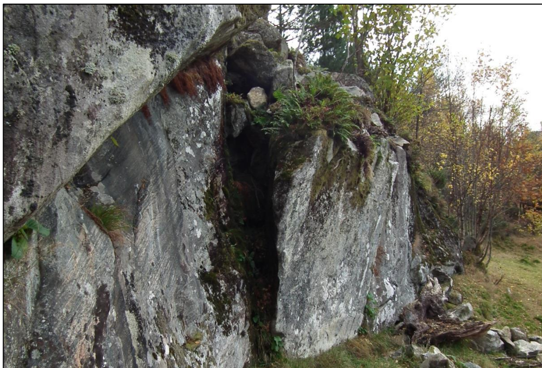
Figur 23: Avgrenset kile med løse blokker i bakkant i en skrent ved lokalitet E.
