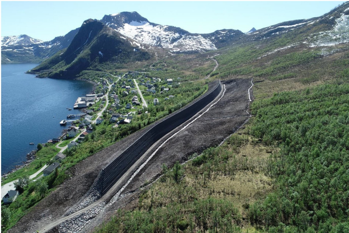
Figur 3: Dronefoto over Fjordgård med ny skredvoll, tatt 17.06.2020. Foto oversendt av oppdragsgiver.
