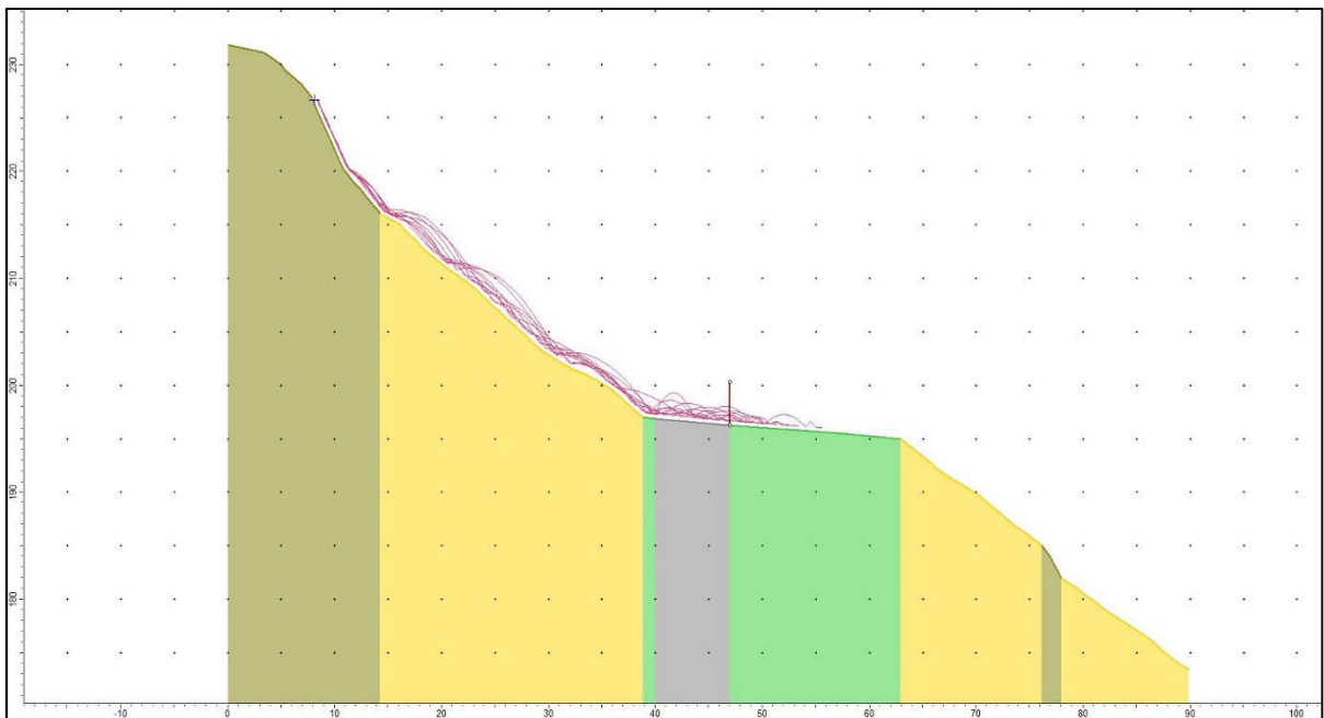
Figur 7: Steinsprangsimulering på Profil 2
