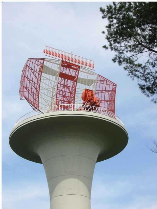
Figur 3 Luftfartsradar med den mindre antenna for sekundærradaren montert oppe på den større antenna for primærradaren (bilde Wikipedia)
