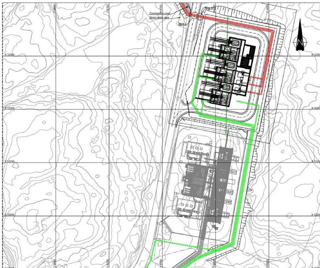
Figur 4-4 Tomteopparbeidelse nord for eksisterende Martin Linge bygning.
