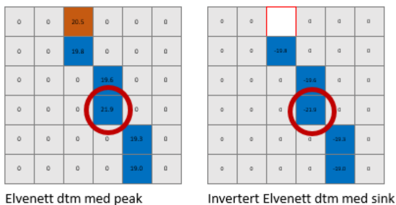
Figur 9. Metode for å fjerne «peaks» ved å gjøre dem om til «sinks».
