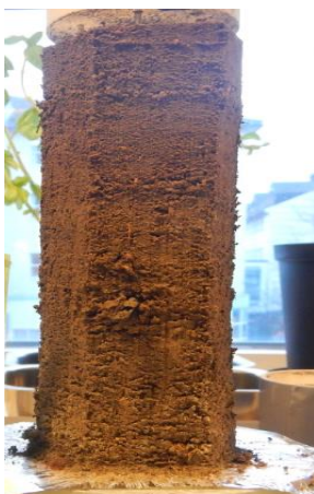
Høyre: Bit til treaksialt trykkforsøk
