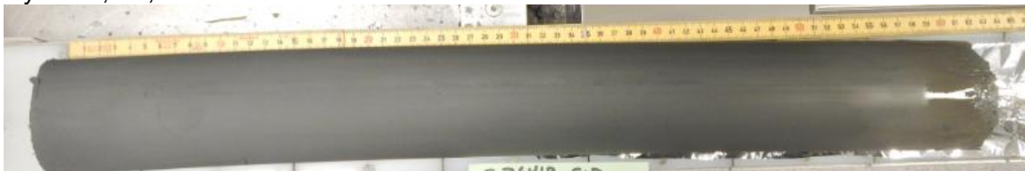
Høyre: Bit til treaksialt trykkforsøk
