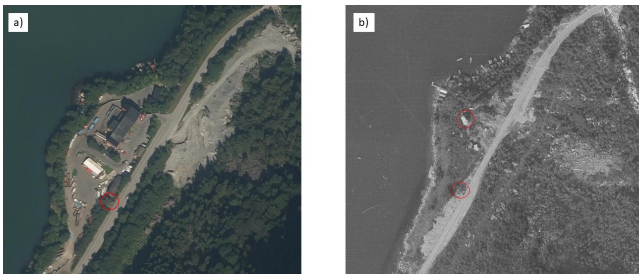
Figur 11 - Bilde a) er dagens situasjon med miljøstasjonen. Bilde b) er fra 1964 og viser et utbygget område med flere store blokker av økende størrelse ned mot fjorden. Eksempel på store blokker med langt utløp er indikert med rød sirkel på begge bildene.
