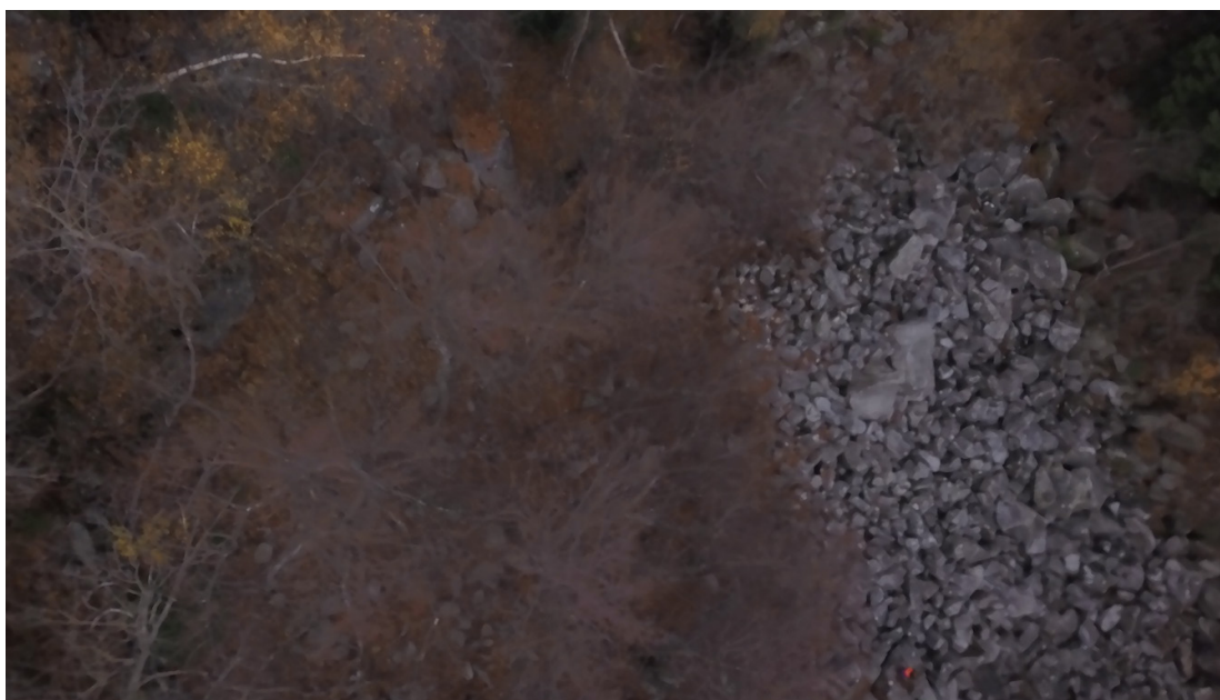
Figur 3-14. Observasjon fra nedre del av ura, Askane sør. Den vegetasjonskledde ura skiller de to urene. Det er antydning til forskjeller i blokkstørrelse i urene, med største blokker nederst.
