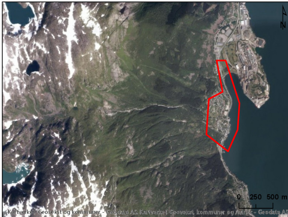
Figur 3-7. Flybilder over området. Sport etter snøskred er synlig som vegetasjonsvariasjoner.
