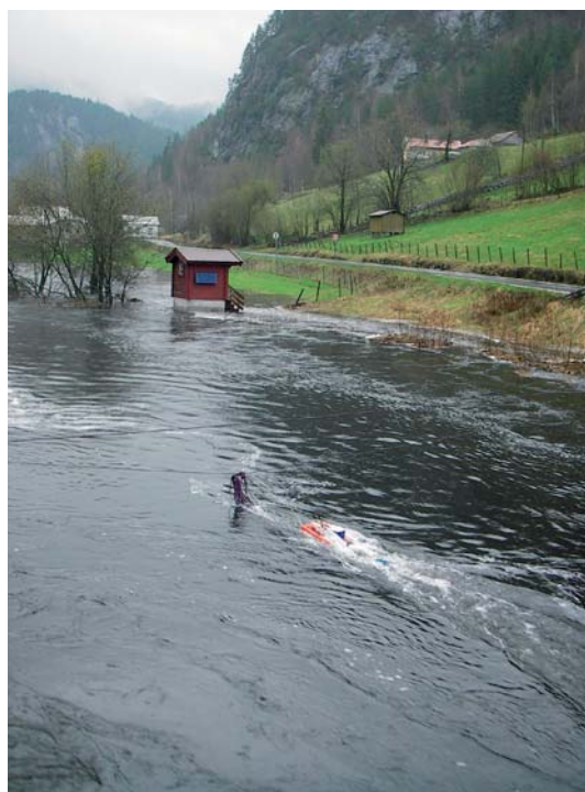
Figur 1. Målestasjonen 20.2 Austenå i Tovdalsvassdraget. Stasjonen er styrt med bl.a. et solcelleanlegg for å skaffe strøm til både vannstandslogger og fjernoverføring av data. Bildet er fra 1. mai 2008, da det var flom i vassdraget. En wire med måleinstrument er spent opp noen meter nedstrøms stasjonen for å gjennomføre vannføringsmålinger under flom (se også figur 3). Foto: Vibeke Svenne, NVE.
