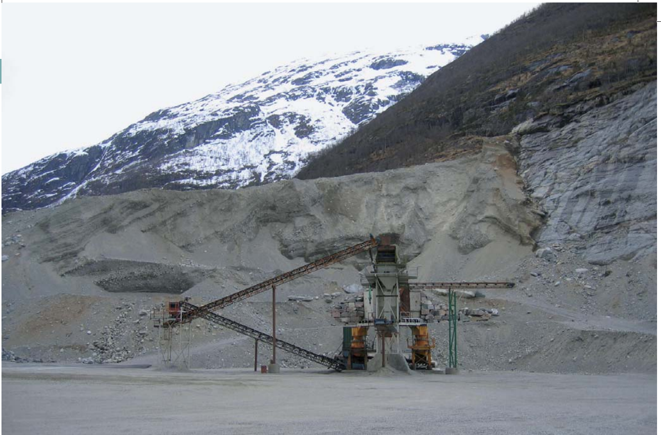
Figur 9.2 Grustak med sorteringsverk og lagringsplasser for ulike grusfraksjoner. Sunndal, Møre og Romsdal. Foto: Einar Sæterbø.
