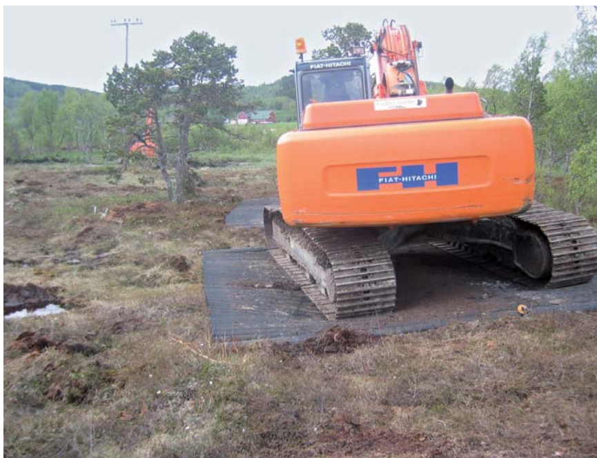
Figur 7.2 Transport i veiløst terreng på belastningsmatter ved Børselva i Ballangen. Hensikten er å skåne myr og våtmark i et naturreservat. Foto: Gunnar Kristiansen.
