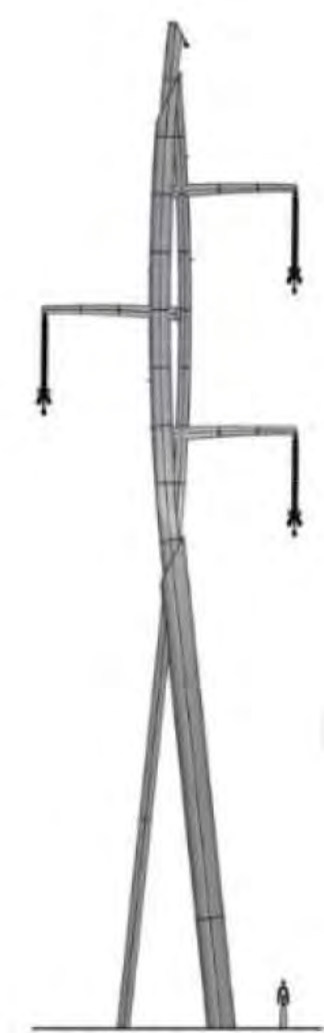
Figur 1-16. Mastetype Strå. Illustrasjon fra Statnett.
