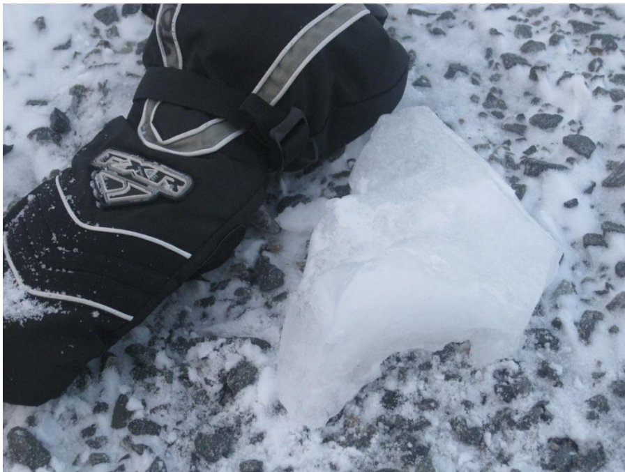
Figur 4 Isbit som ble funnet 25m fra tårnet i en vindturbin Kjøllefjord 29.mars 2008.
