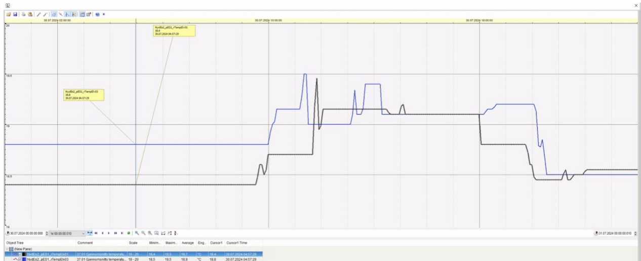
Figur 3: Temperatur av Akerselva før vanninntaket (svart strek) vs. etter vannutløpet (blå strek) vist for 30.07.2024 der det framkommer at maks. temperaturendring var 0.4 grader.
