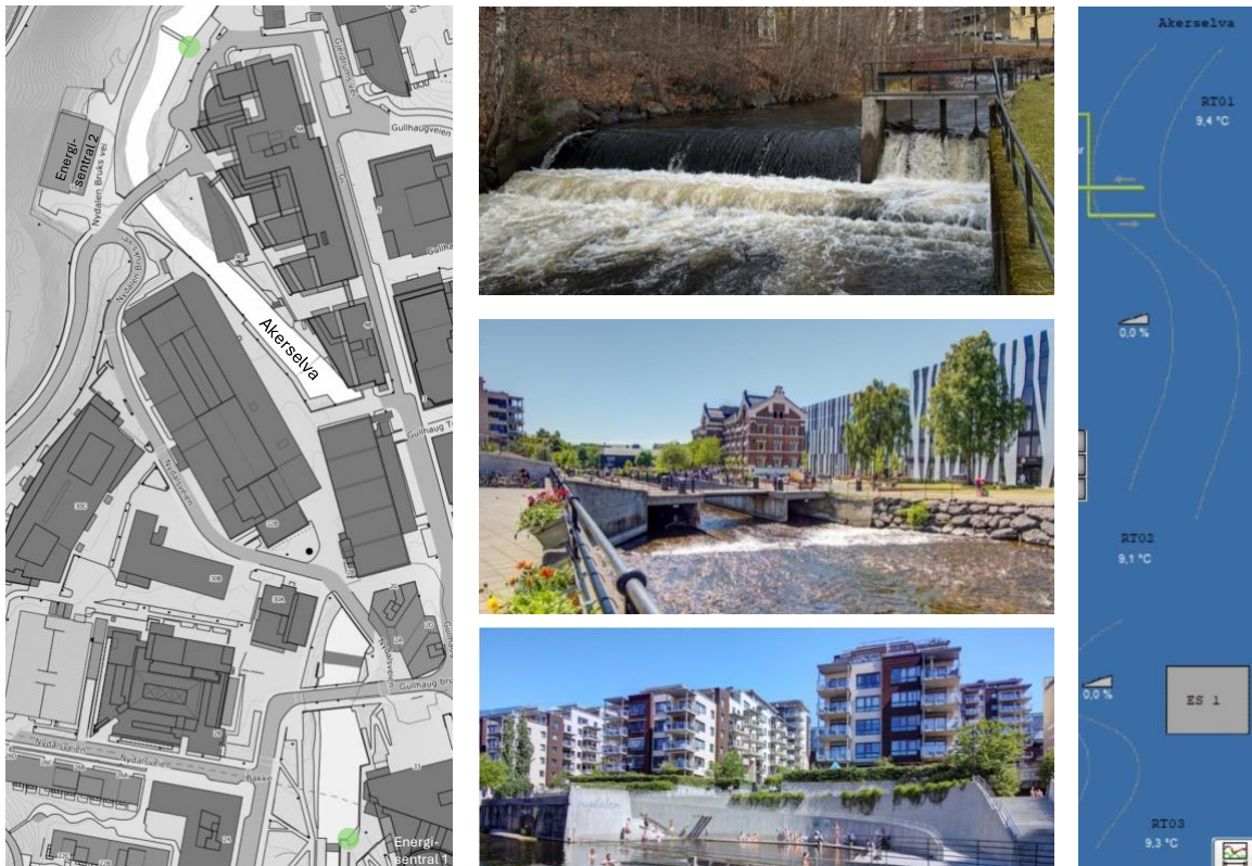
Figur 6: Lokasjon av vanninntak, vist med grønn runding. Det nedre ble bygd i 2002 og er ca. 50 m nedenfor Gullhaug bru (inni venstre kulvert på midterste bilde) og i 2013 ble et eldre vanninntak ombygd til Nydalen Energi ca. 50 m nordøst for Nydalen Bruks vei 16. Badekulpen ved nederste utløp ses nederst i midten og elvetemp-følere vises til høyre.
