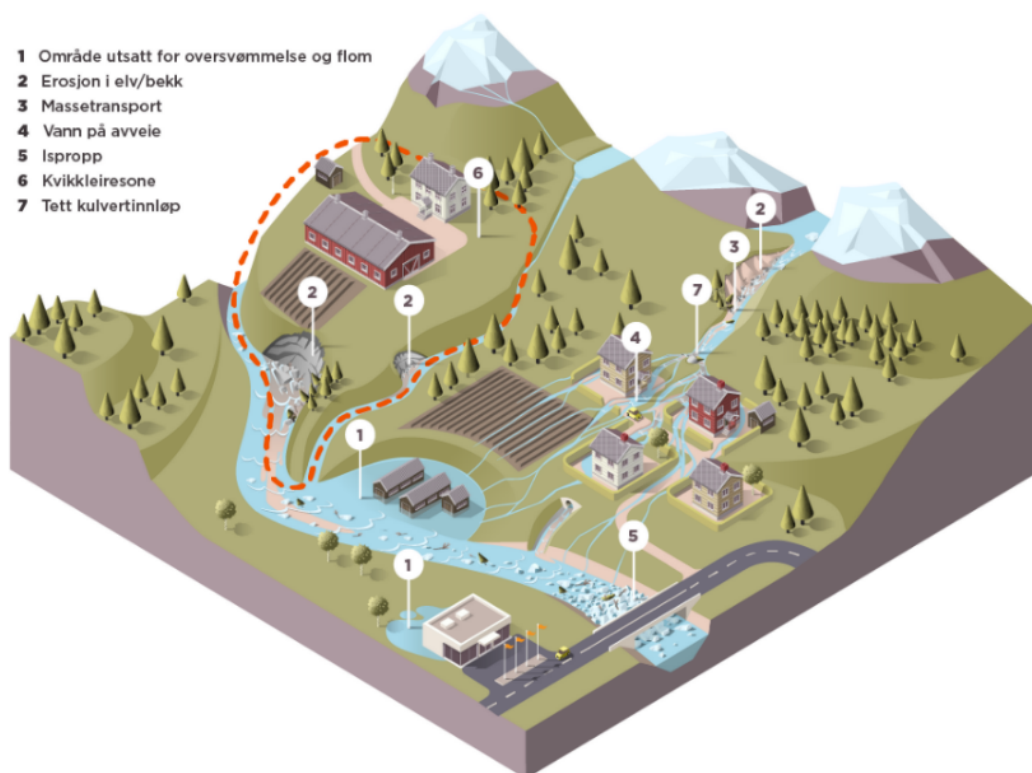
Figur 2-7: Illustrasjon over typiske problemer knyttet til oversvømmelse og flom (NVE, 2022a).
