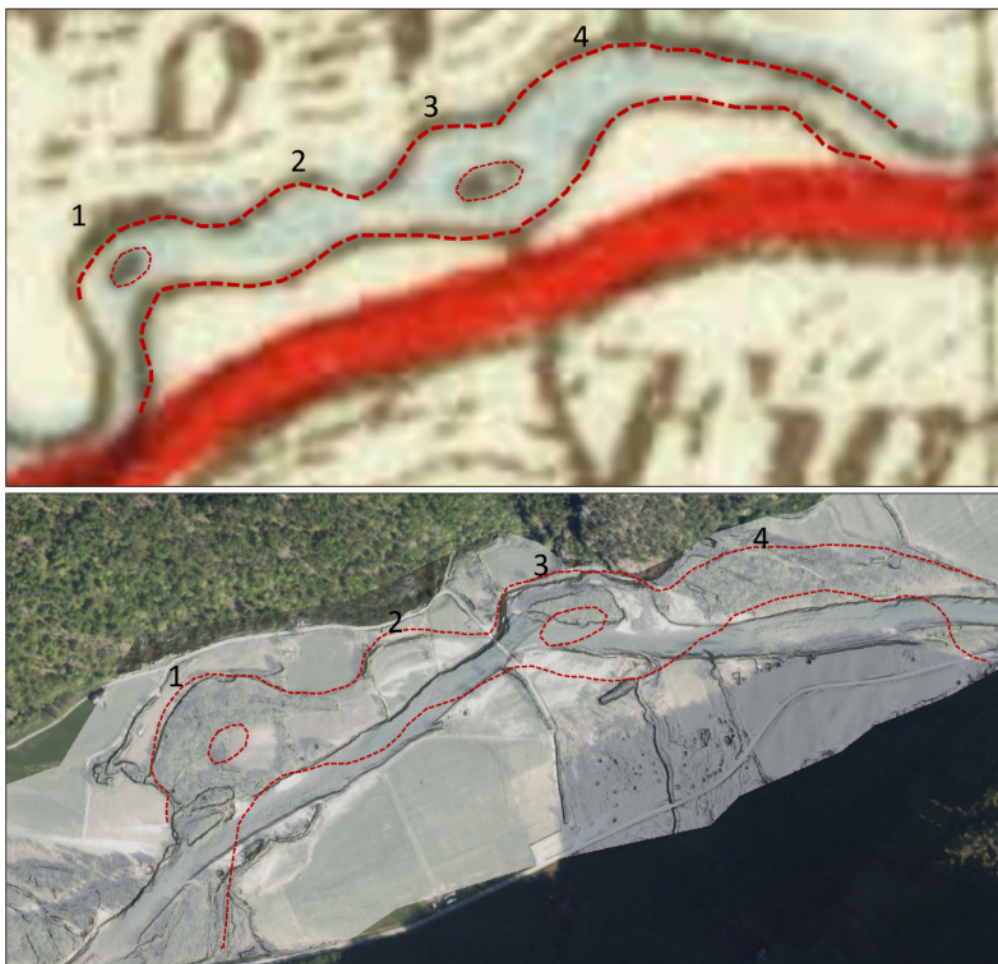
Figur 3-4: Sammenligning av kartgrunnlag fra år 1900 med terreng og flyfoto fra 2022. Elveleiet rundt Bjørnsteinsøy gikk tidligere lenger nord i dalen, og den historiske elvebredden kan også kjønes igjen på terrengdata fra 2022.
