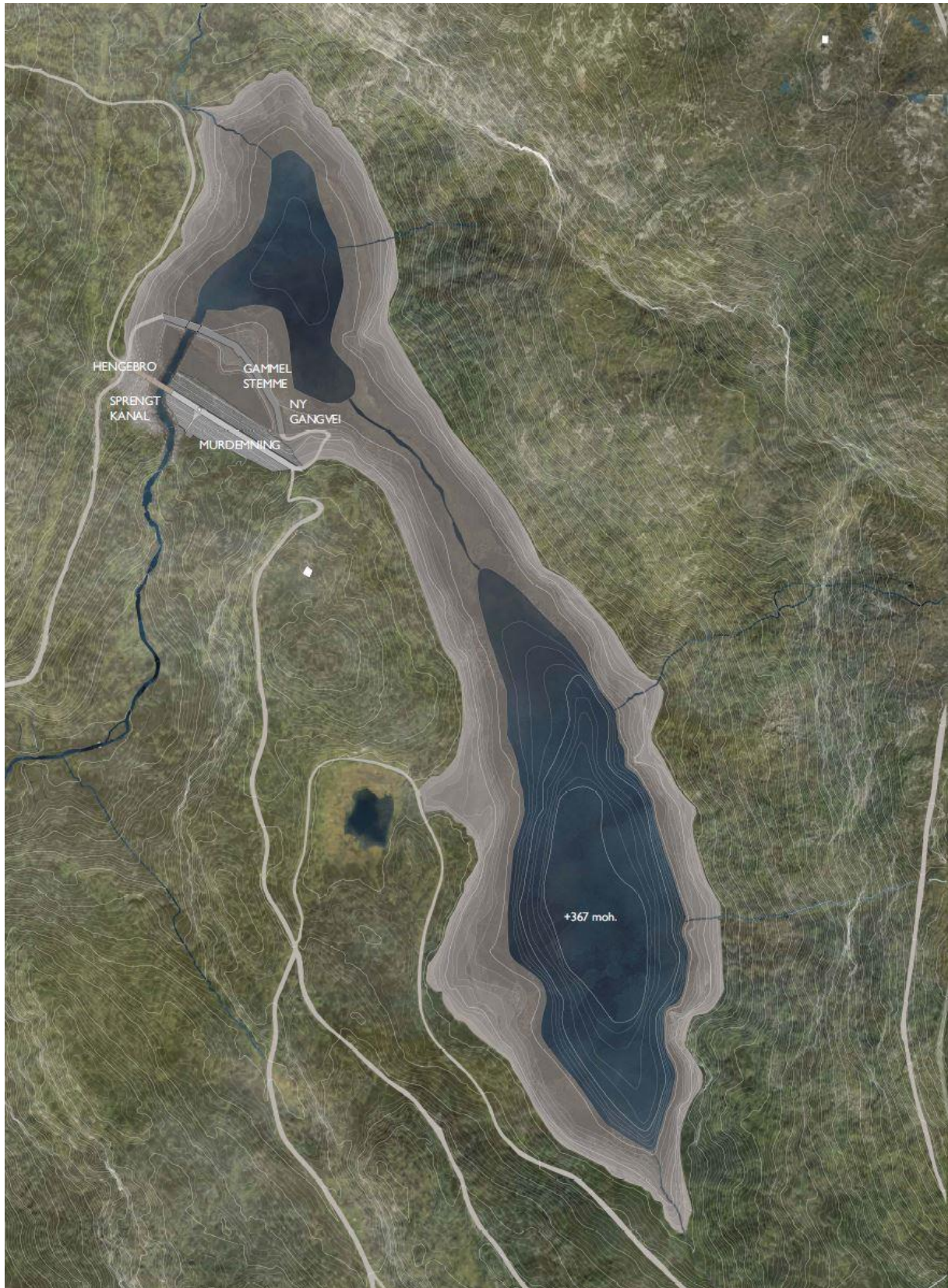
Figur 12: Mulig vannstand (367 moh) ved planlagt tiltak. Det grå området er områder som i dag er dekt av vann, men som blir eksponert etter nedleggelsen av Dam Stordiket. Ny kanal og bro i nordvestre del av området. Den gamle dammen «Den gamle stemme» krysser også den nye kanalen, litt lenger nord.
