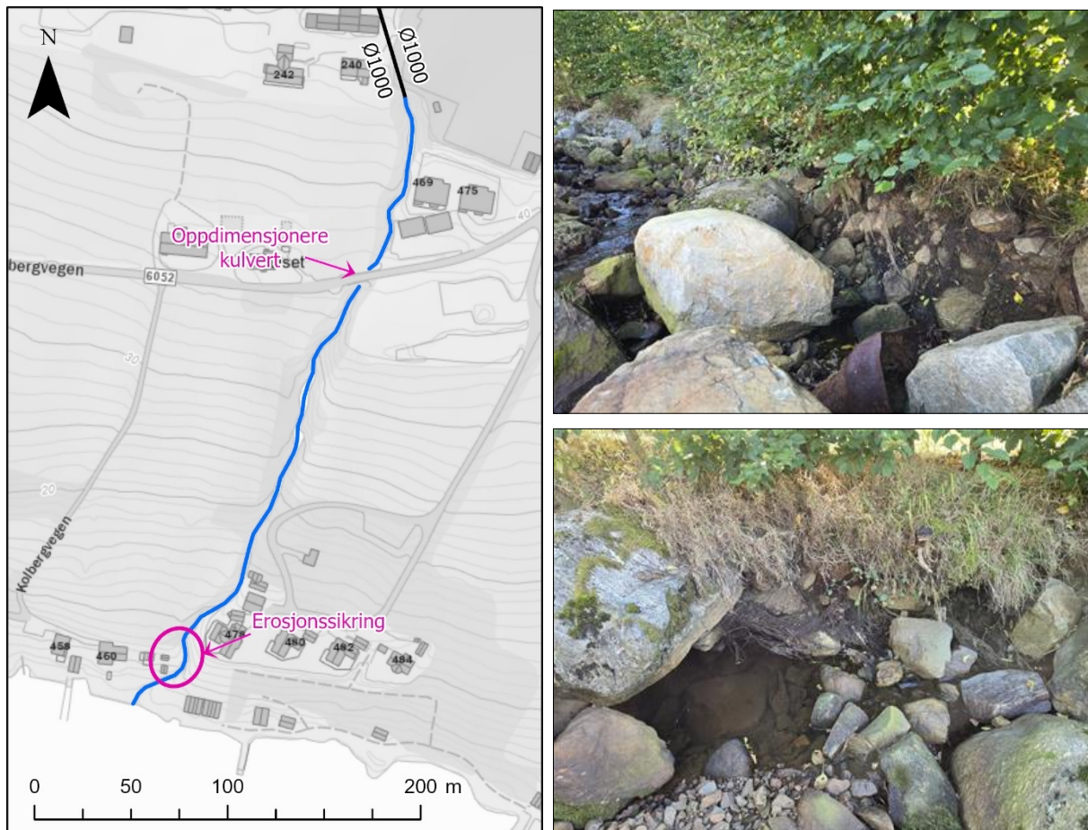
Figur 5-4 Kart som viser mulige avbøtende tiltak nedstrøms planområdet for å avbøte effekter av økt avrenning. Det er trolig kun nødvendig med sikring i det bekkepartiet som allerede er utsatt for erosjon (som vist på bilder).
