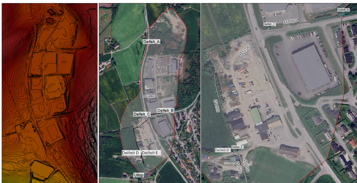
Figur 3-4 Utsnitt av terreng og geometri i todimensjonal hydraulisk modell i programmet HEC-RAS.
