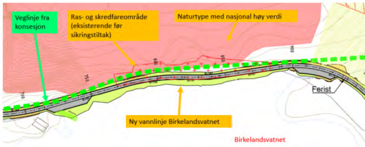
Figur 4: Profil 700-920 Veglinje mellom Birkelandsvatnet og fjellskjæring
