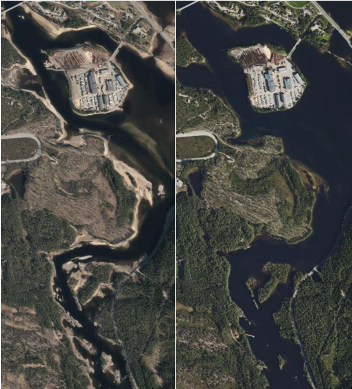
Figur 1. Flyfoto av Vassenden sør i Byglandsfjorden hvor det er foreslått tiltak. Til venstre sees strandsonen på lav vannstand (dvs. i overkant av kote 200), til høyre vises området på relativt høy vannstand (ca. kote 202) som er gjeldende for sommermånedene. Øverst til venstre i bilde sees Vassendbrua.
