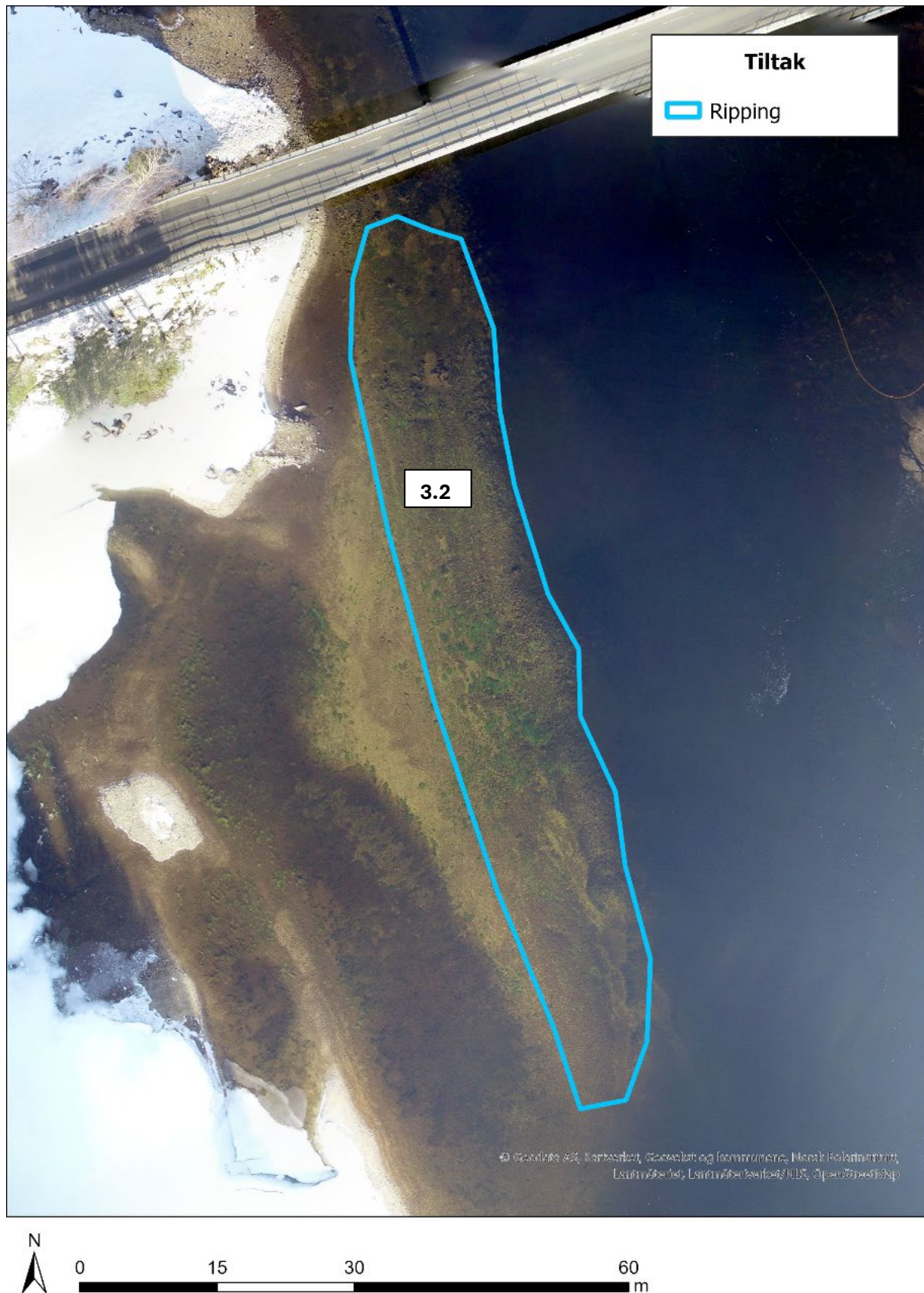
Figur 37. Tiltaksområdet 3.2 hvor det er anbefalt å rippe en grusbank på vestre bredd nedstrøms Vassendbrua.
