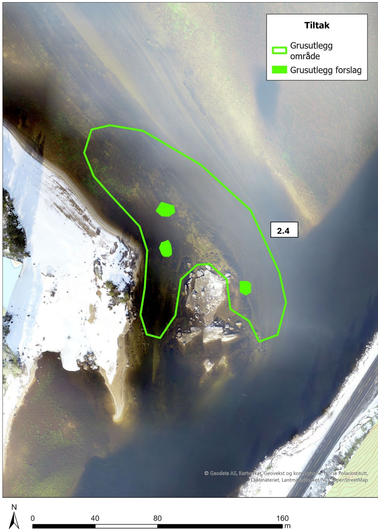
Figur 27. Detaljkart av tiltaksområde 2.4. ved «skjæret» nedstrøms Vassendøya. De grønne punktene illustrer hvordan grusen som legges ut vil bli spredt på mindre flater innenfor tiltaksområde.
