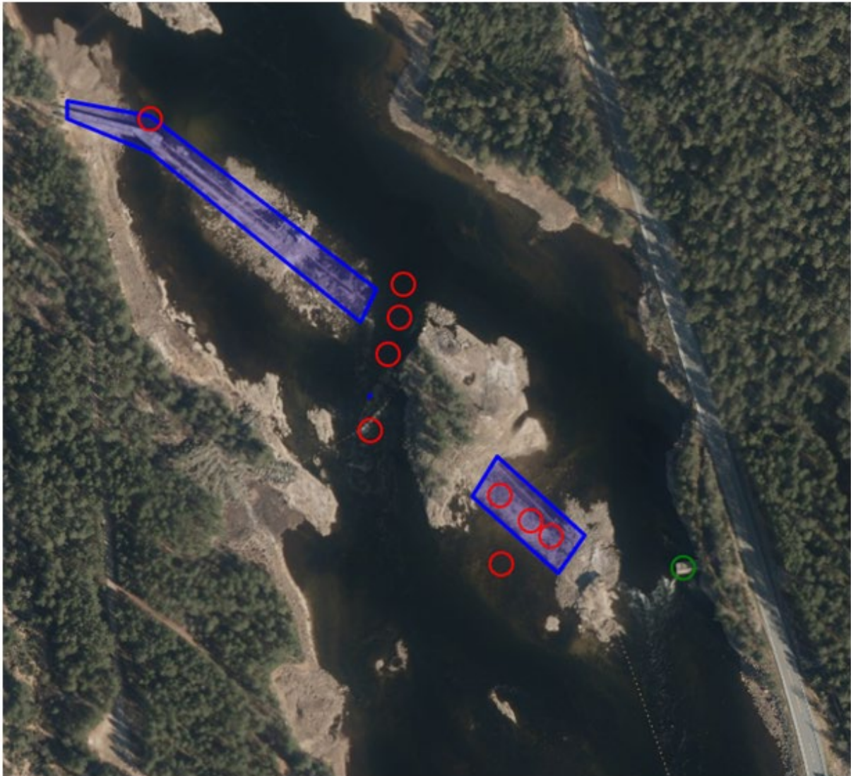
Figur 41. Figur oversendt av Bygland Kommune v/Nils Børge Kile. Den grønne sirkelen viser området hvor det ble gjennomført tiltak med utlegging av grus høsten 2025. Arealet i blått er bunnfundament fra nåledammen som kan fjernes og røde sirkler er foreslåtte områder for grusutlegg.
