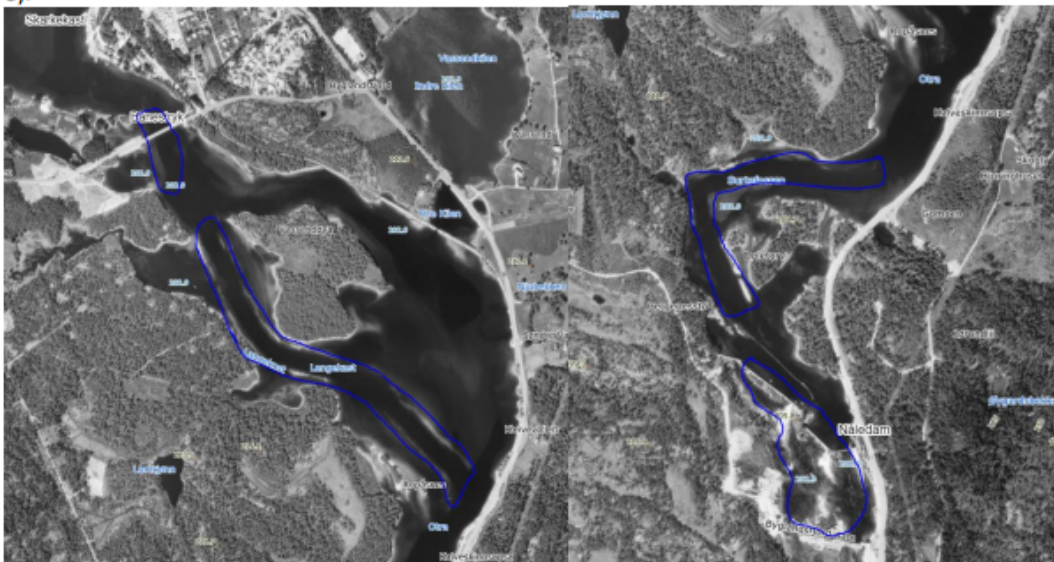
Figur 8. Blå markering på flyfotokart viser areal kor det er utført mudring- og sprengingsarbeid i Vassenden (Norge i bilder 1973).
