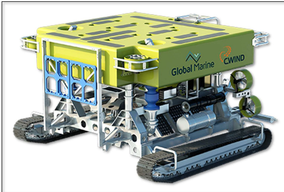
Figur 3-6. Undervannsfarkost for kabelinstallasjon.. Kilde: global-marine.co.uk
