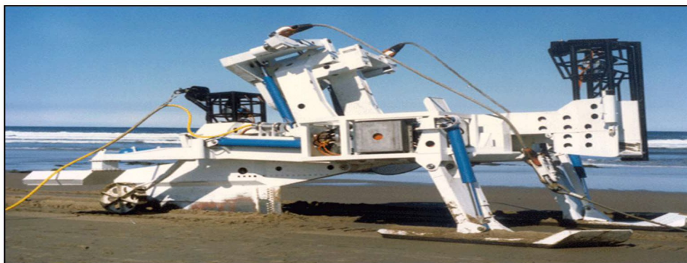
Figur 3-7. Undervannsfarkost for kabelinstallasjon ved pløying. Kilde: kis-orca.eu
