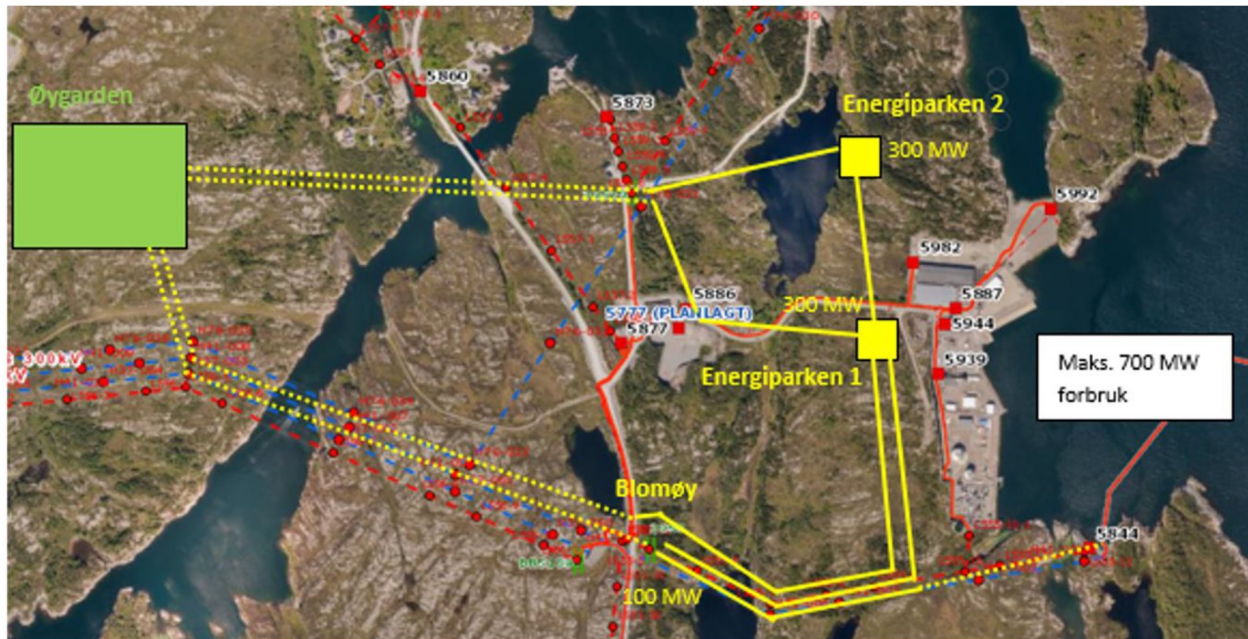
Figur 8. Kartskisse som viser planlagt fremtidig 132 kV nettstruktur for forsyning av Energiparken næringsområde. Transformatorstasjon «Energiparken 1» og 132 kV overføringer mellom nye Øygarden koblingsstasjon og Energiparken vil bli konsesjonssøkt senere. Transformatorstasjonen kalt «Energiparken 2» blir aktuell først når tilgjengelig effekt og eventuelt behov er til stede, noe som først skjer etter 2030. Plassering av traseer og transformatorstasjoner i Energiparken er ikke endelig fastlagt.
