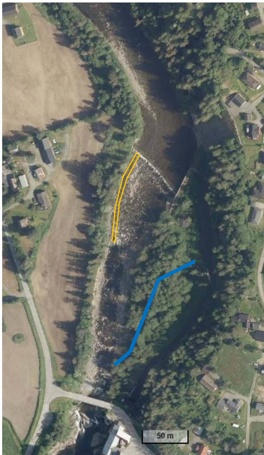
Bilde 3 Terskelen ligger nedstrøms en sving i elva. Det foreslås modifisering av elva med graving av et bekkeløp mellom de oransje strekene. Eksisterende bekkeløp nedstrøms fisketrappa er markert med tykk blå strek.
