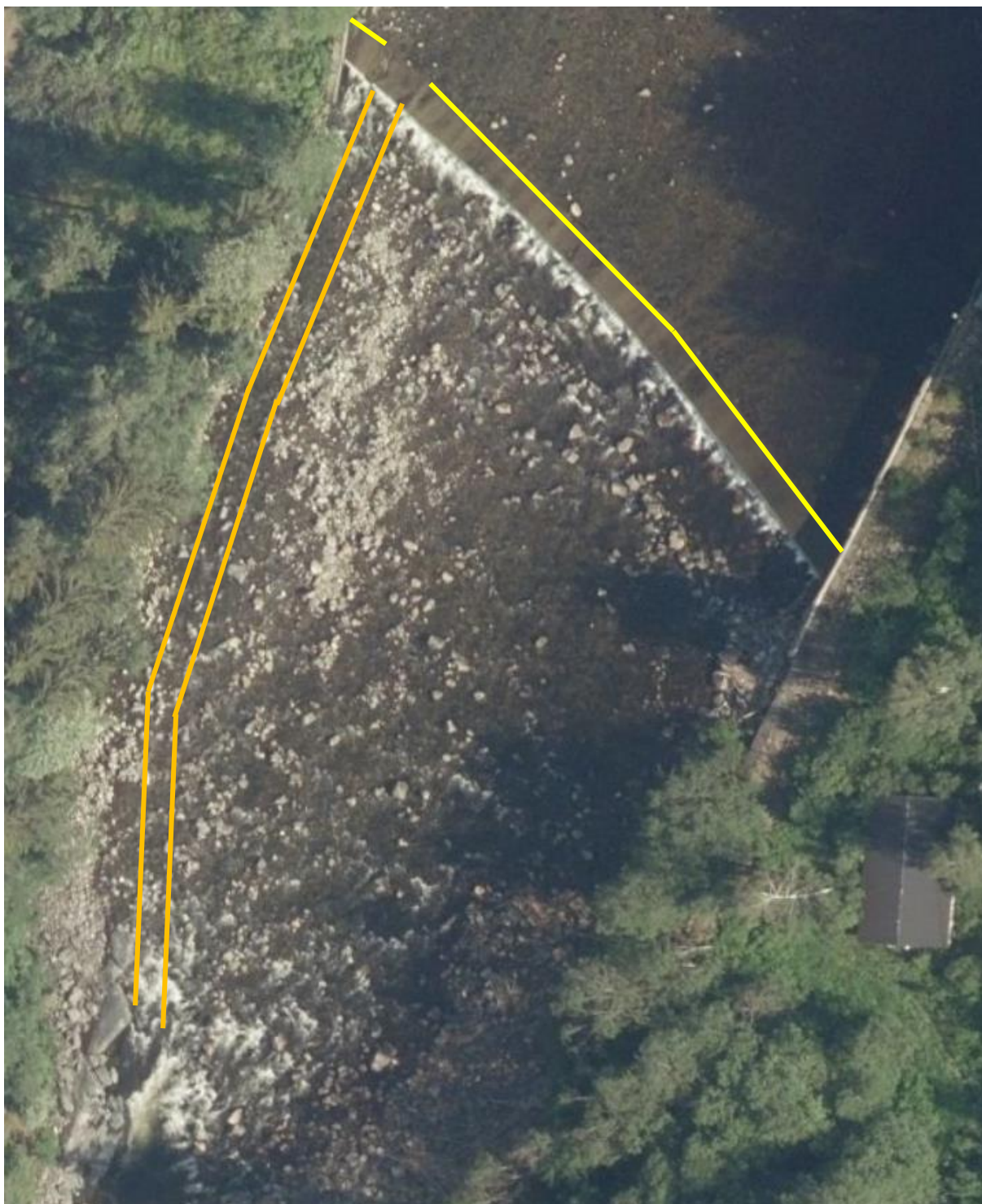
Bilde 2 Terskelen planlegges modifisert. Den forhøyes 10 cm på de delene marker med gul farge for å samle vannet i den vestre delen av elva. Videre planlegges det å grave et bekkeløp mellom de oransje strekene.
