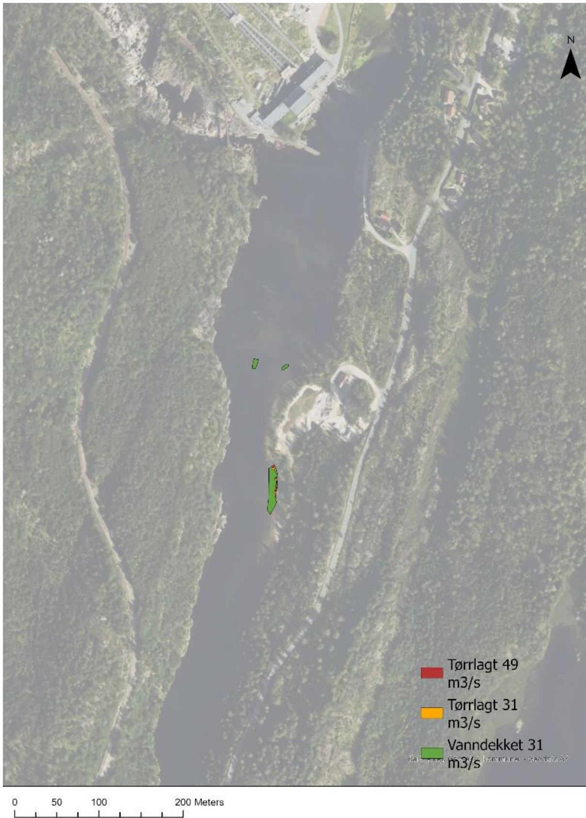
Figur 8. Tørrlagt potensielt gyteareal ved 31 m 3 /s (oransje), 49 m 3 /s (rødt) og gyteareal som fortsatt er vanddekket ved 31 m 3 /s (grønt) i delstrekning ved Bøylefoss
